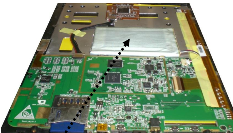
Eingeklebter Akku in einem hier noch relativ einfach zu öffnenden Gehäuse eines Tablet-PC.
