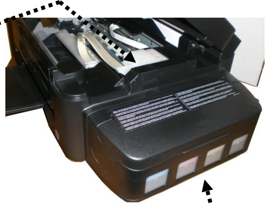
Tintenstrahl drucker mit vier großen Tintentanks („Ecotank“)
