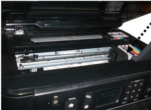
Tintenstrahl drucker mit vier Farbpatronen für s/w- und Farbdruck
